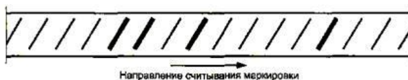
Рисунок 2 - Пример прокатной маркировки предприятия-изготовителя под номером 14
